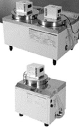
初乳・移行乳 加熱殺菌装置
